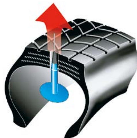
Bild 8: Funktion eines ‚Mini-Combis‘ (Gummi-Reparaturkörper). Bild: Rema TipTop
