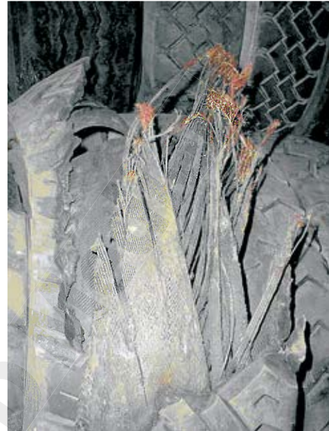
Bild 7: Reifenschaden durch Unterrostung. Bild: Rema TipTop
