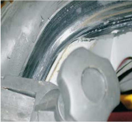
Bild 18: Niederhalter in alter Form mit deformierter Wulst.
