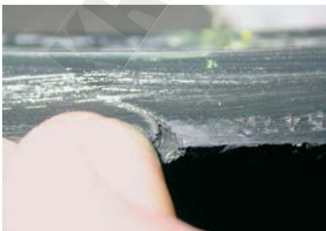
Bild 3: Montageschaden durch RFT-geeignete Montiermaschine.
