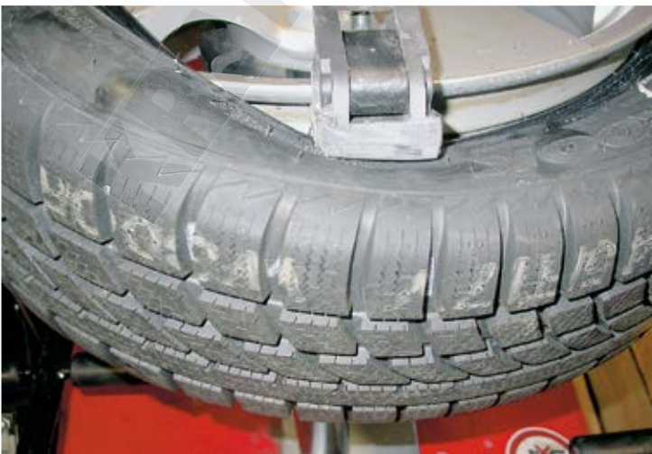
Bild 5: Traktionspunkt bei der Montage.
