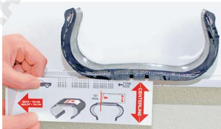
Bild 4: Wo darf repariert werden? Schablone von Rema TipTop. Bild: Blenk
