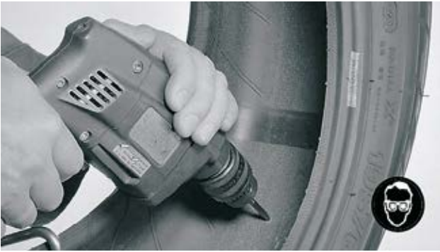
Bild 11: Richtiges Ansetzen des Fräasers. Bild: Rema TipTop
