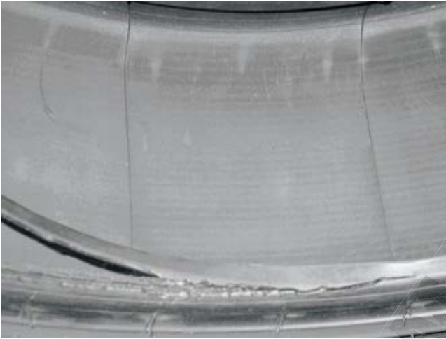
Bild 1: Runflat-Reifen aus Erstgutachten: Die Untersuchungen an zirka 50 Reifen zeigten auf, dass bei 48 Reifen Merkmale, Fehler und Schäden von der Montage oder Demontage vorhanden waren. Bilder: Immler
