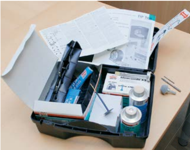
Bild 5: Runflat-Repsset inklusive Fräsern, Spezialzement ,BL', Mini-Combi-Einsätzen und einer ausführlichen Reparaturanleitung. Bild: Blenk
