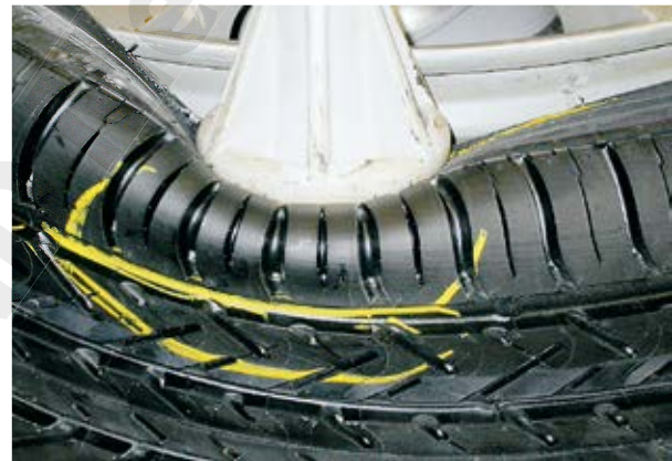
Bild 7: Starke Deformation durch ungeeigneten Niederdrücker.
