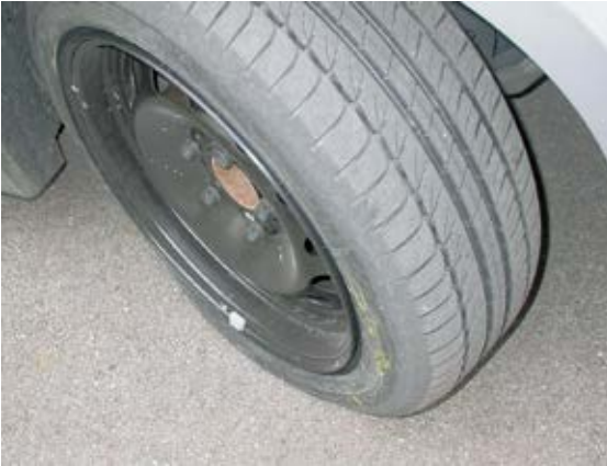
Bild 4: Testfahrt mit Runflats bei einem Druck von 0,0 bar.
