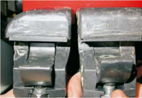
Bild 8: Verbesserter Niederdrücker schont den Reifen.
