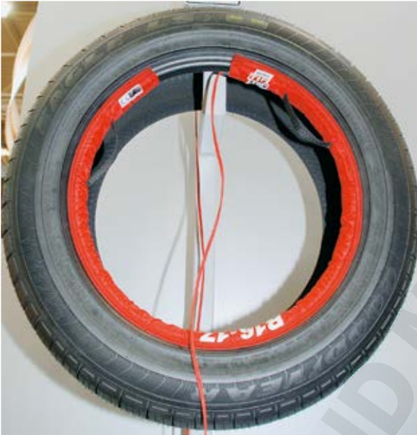
Bild 11: Wulstheizung: Hilfe bei der Montage? Bild: Blenk
