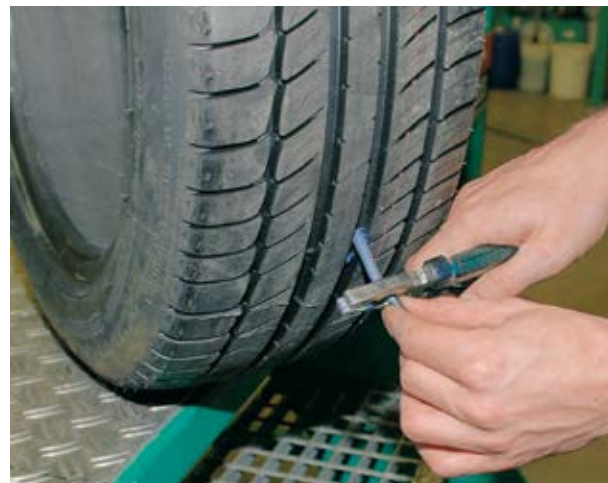
Bild 14: Durchziehen und (bündiges) Abschneiden des überschüssigen Schaftes an der Laufflächenaußenseite. Bild: Blenk
