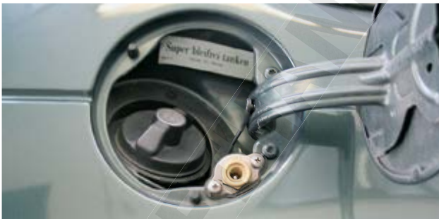
Abbildung 54: Tankeinfüllstutzen ohne Schutz.
