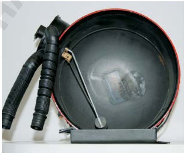
Abbildung 78: Ausgewinkelter Zylindertank mit Multiventil.
