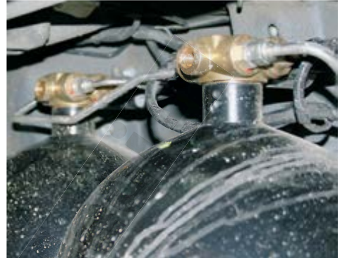
Abbildung 86: Angeschlossene Tankarmaturen am CNG-Tank.
