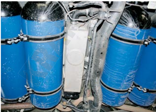
Abbildung 85: CNG-Zylindertanks am Fahrzeugunterboden montiert.
