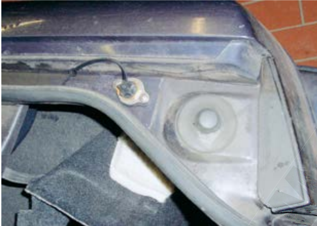
Abbildung 53: Tankeinfüllstutzen von Heckklappe verdeckt.
