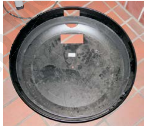
Abbildung 66: Schutz für Unterflurtank.
