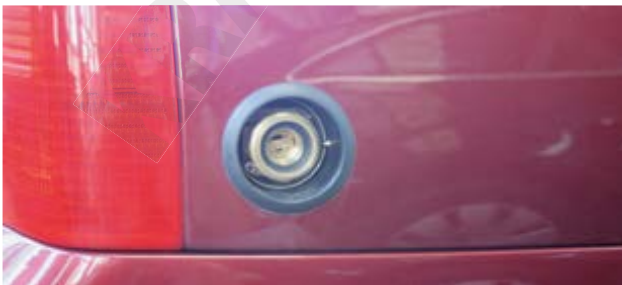
Abbildung 55: Einfüllstutzen mit Einbautopf.
