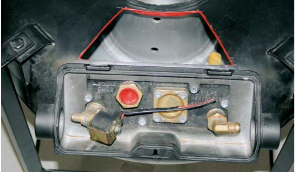
Abbildung 81: Tankarmaturen eines Vierlochtanks.
