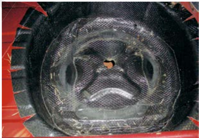
Abbildung 59: Reserveradmulde ausgekleidet mit Terodem.
