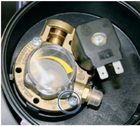
Abbildung 72: Multiventil mit Angabe des Einbauwinkels (Flanschstellung, hier: 30°).
