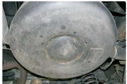
Abbildung 67: Unterflurtank ohne Tankschutz nach einem Jahr.
