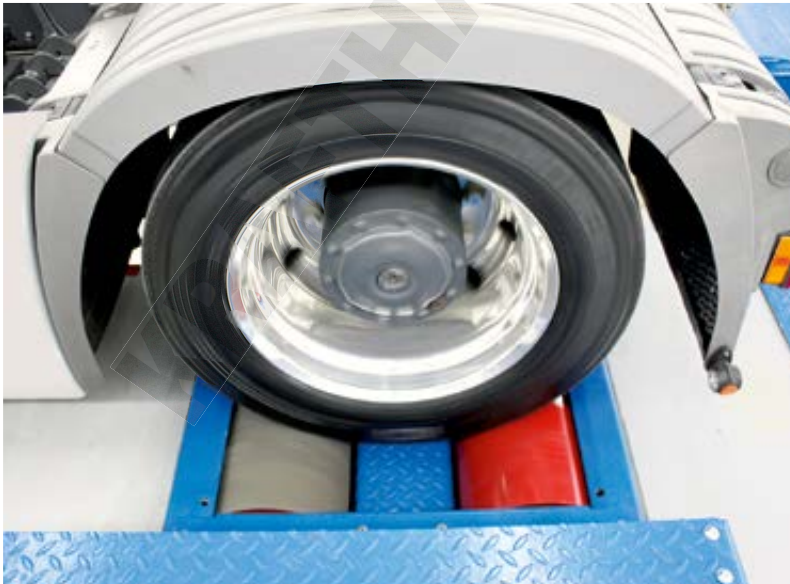
5.5 Die Masse macht's: Die rotierenden Massen eines schweren Nutzfahrzeuges müssen eigens gemessen werden, um die Leistungsmessung nicht zu verfälschen.
