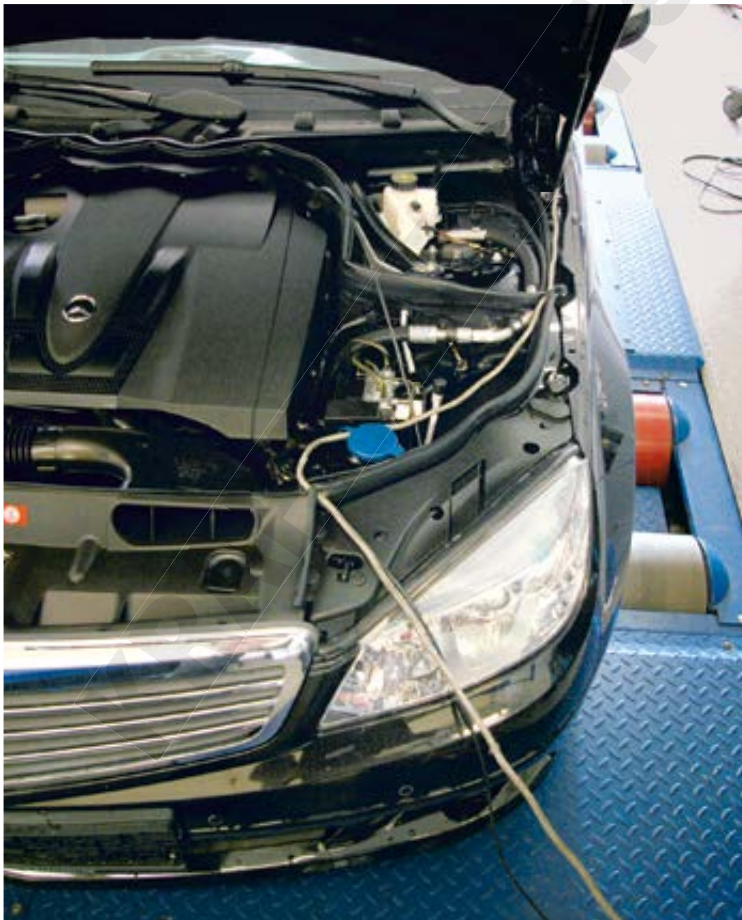
5.12 Strippen ziehen: Alle Kabel müssen sicher verlegt sein – auch bei akti- vem Hauptgebläse. Bild: Vierling
