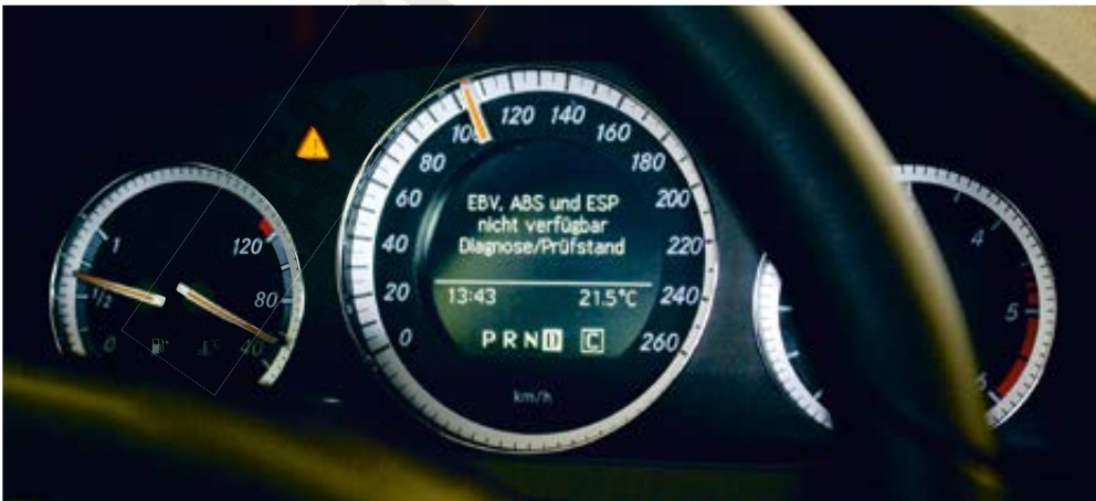
5.16 Die Ausnahme: Fahrzeug-Stabilisierungsprogramme und Fahrwerksregelsysteme sind nicht immer einfach zu deaktivieren. Nur die wenigsten Hersteller bieten gar einen speziellen Prüfstandsmodus. Bild: Vierling
