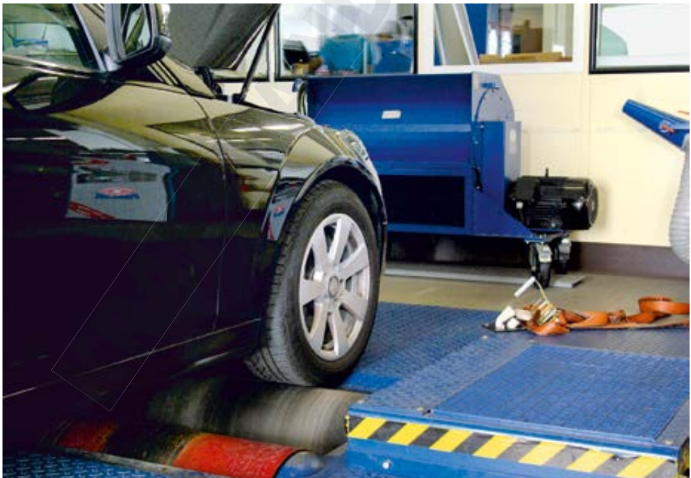
5.9 Einstellungssache: Allradprüfstände müssen an den Radstand des Fahrzeuges angepasst werden. Im Einachsbetrieb wird die nicht mitlaufende Achse außerhalb des Rollensatzes fixiert. Bild: Vierling
