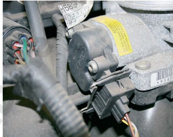
3.1 Drosselklappenpotenziometer: Messung des Öffnungswinkels der Drosselklappe.
