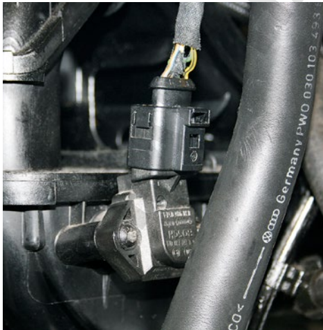
3.6 Kostengünstigere Lösung: Saugrohrdruckfühler / Volkswagen.
