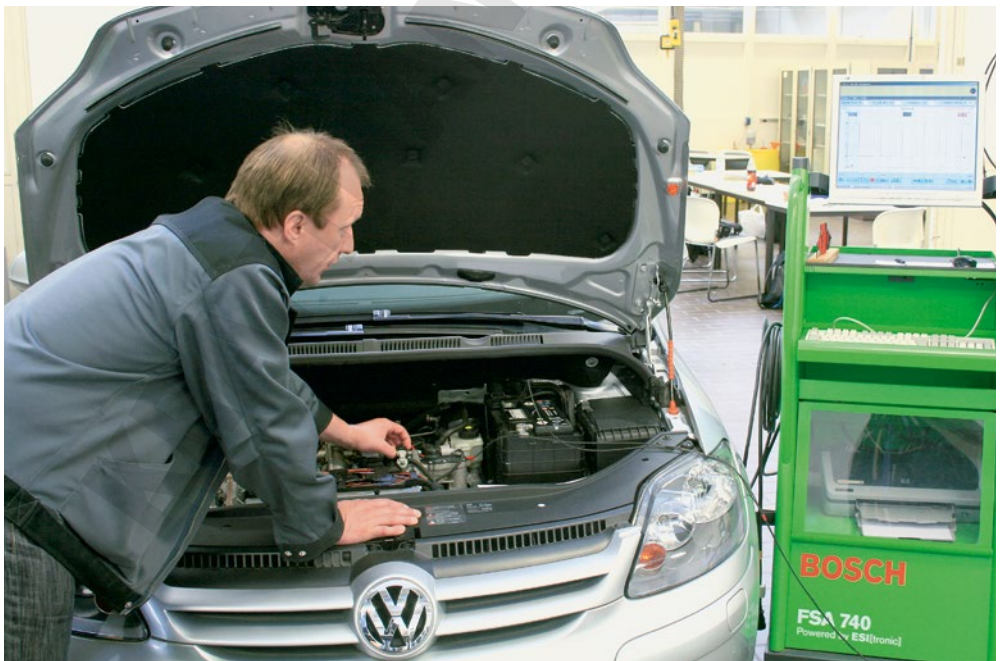
1 Vor dem Tausch: Sensorprüfung mit dem Oszilloskop.
