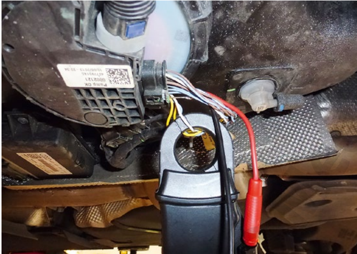
5.9 AdBlue-Fördereinheit mit Förderpumpe.
