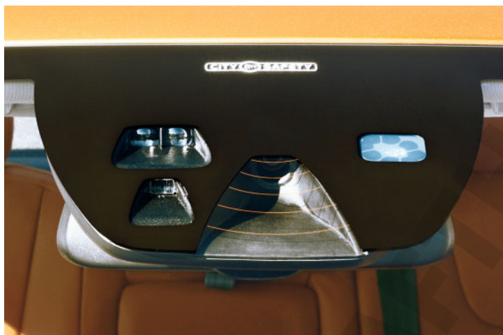
Bild 101 Fußgängererkennung, (Voll-)Bremsassistent: Beim Volvo S60, V60, XC60 sind der Regen- und Lichtsensor (rechts), der Abstandsmesser (links) und eine Videokamera, welche unter anderem für das City-Safety-System (Bremsassistent) benötigt werden, hinter der Windschutzscheibe montiert. Bild: Volvo
