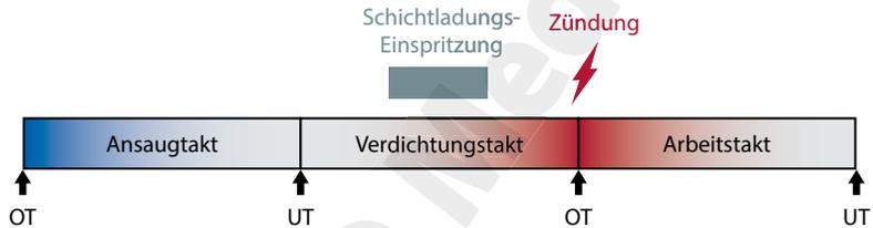
einspritzung in den Verdichtungstakt ein mageres Gemisch bereitet. Nach der Entzündung des Kraftstoffs wird noch einmal im Arbeitstakt eingespritzt. Dieser Kraftstoffanteil verbrennt sehr spät und heizt durch die zeitliche Nähe zum Öffnungspunkt des Auslassventils den Abgasstrang stark auf.
