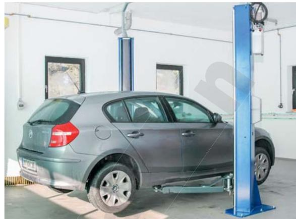
**Bild 17** Hydraulisch angetriebene Zweisäulen-Überflur-Hebebühne. Oben rechts sitzt der Motor, der den Öldruck aufbaut. Bild: Rudolf Guranti
