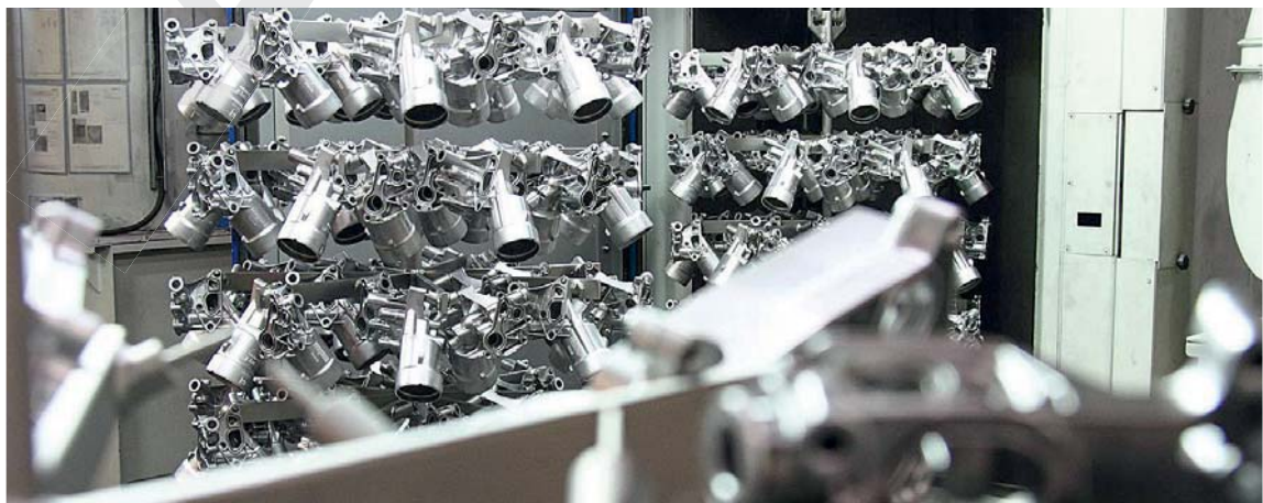
Bild 33 Strahlanlage in der Gießerei bei Hengst in Münster. Bild: Hengst
