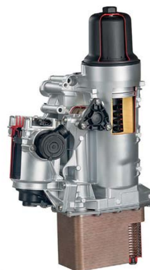
Bild 31 Fluidmanagement-Modul für DAF-Lkw mit Feinölabscheidung. Bild: Hengst
