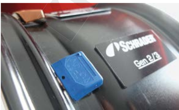
Bild 13 Drucksensor, Generation 2/3 von Schrader. Bild: Blenk
