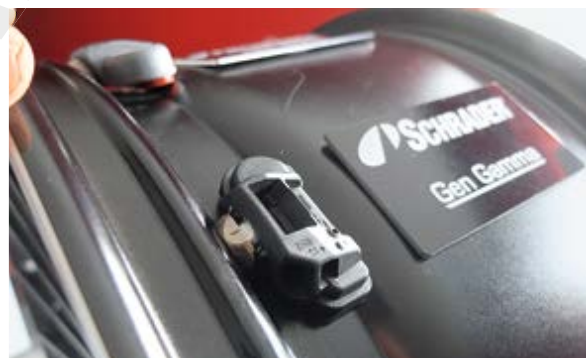
Bild 14 Drucksensor von Schrader, Generation Gamma. Bild: Blenk
