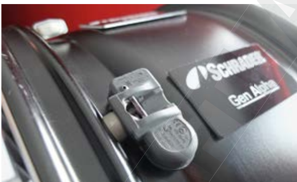
Bild 12 Drucksensor von Schrader, Generation Alpha. Bild: Blenk
