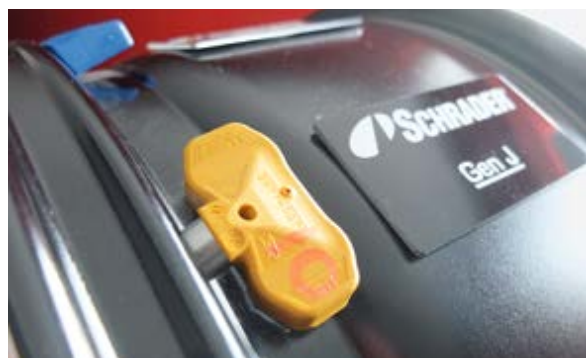
Bild 15 Sensor der Generation 'J' von Schrader. Bild: Blenk
