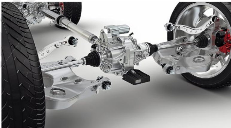
3.6 Hinterachsgetriebe inklusive Differential des Range Rover Sport 2019. Zwei integrierte Kupplungen sorgen für die optimale Drehzahlverteilung (Torque-Vectoring). Bild: Jaguar Land Rover Limited
