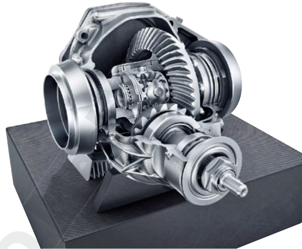
3.7 Kegelradanordnung bei einem mechanischen Hinterachs-Sperrdifferenzial eines Mercedes-AMG SLC 43. Bei Drehzahlunterschieden an den Hinterrädern wird das Drehmoment auf das Rad mit der besseren Bodenhaftung verteilt, um das Durchdrehen zu vermindern. Bild: Daimler AG
