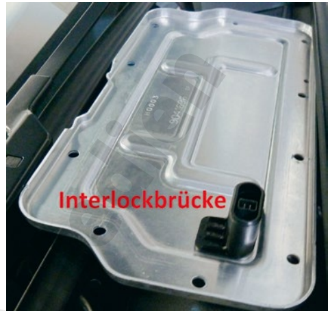
3.8 Interlock-Brücke als einfache Steckverbindung im Gehäusedeckel.
