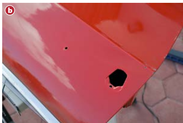
Bilder 106 a–b Farbvergleich: Der Unterschied an der Türgriff-Befestigung – vor dem Schleif- und Poliereinsatz noch sehr deutlich zu erkennen (links) – ist nach dem zweiten Durchgang fast nicht mehr wahrnehmbar. Bilder: Mareis
