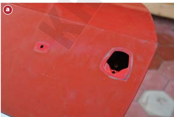
Bilder 106 a–b Farbvergleich: Der Unterschied an der Türgriff-Befestigung – vor dem Schleif- und Poliereinsatz noch sehr deutlich zu erkennen (links) – ist nach dem zweiten Durchgang fast nicht mehr wahrnehmbar. Bilder: Mareis
