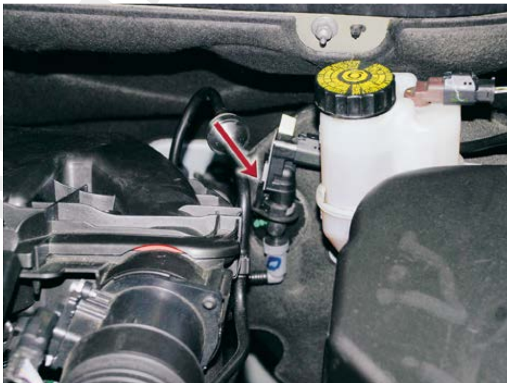
Bild 67 Unter Druck: Der Bremsunterdrucksensor informiert die Start-Stopp-Einheit über den Unterdruck im Bremskraftverstärker. Meist sitzt er, wie im Bild zu sehen, direkt am Bremskraftverstärker. Bild: Schmidt
