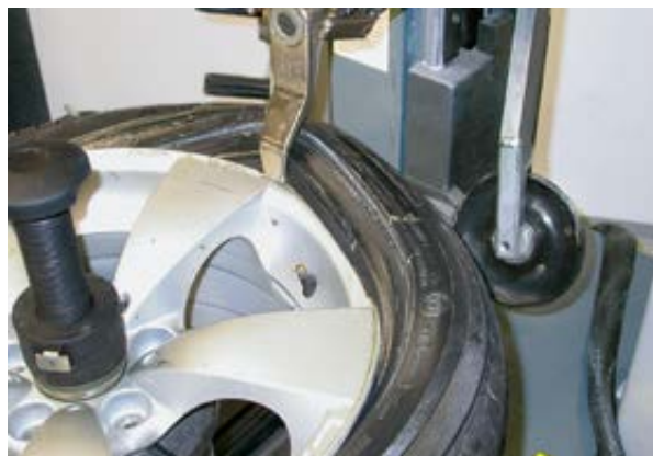
Bild 52 Langsam vorgehen: Reifen langsam drehen lassen und demontieren.
