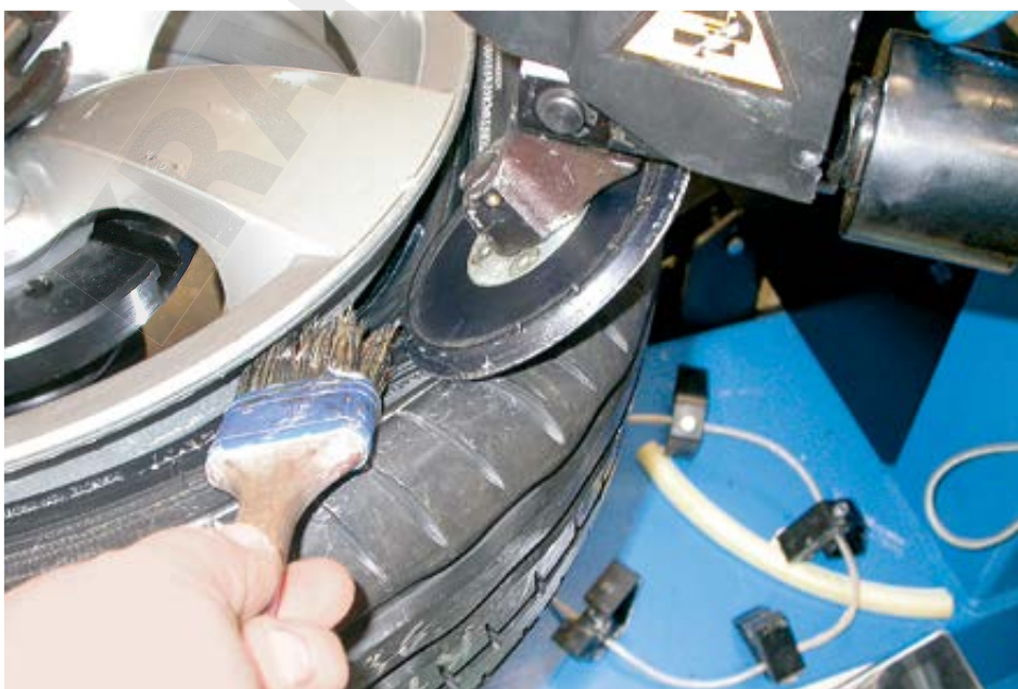
Bild 49 Minimieren der Reibung: Beim Abdrücken zwischen Reifenwulst und Felge genügend Gleitmittel auftragen.
