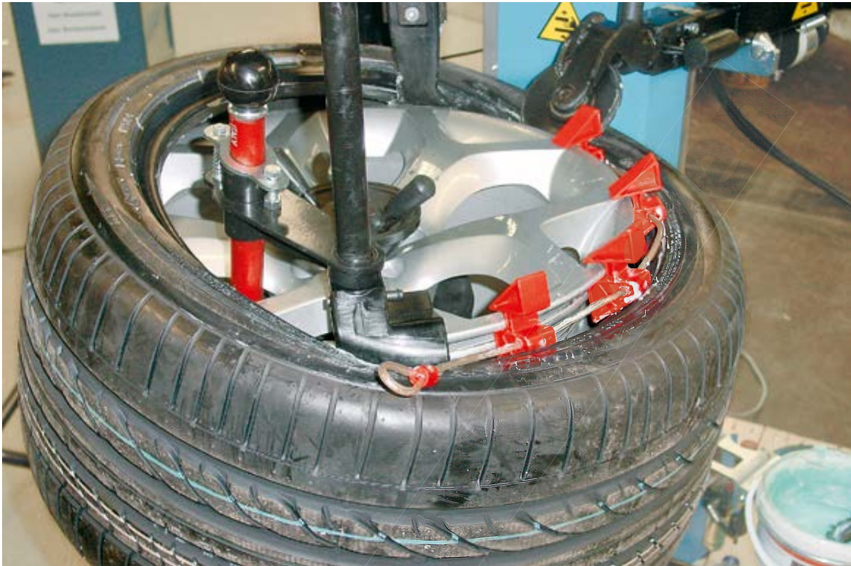
Bild 56 Klemmkeile: Montage der oberen Wulst mit wdk-zertifizierten Hilfsmitteln.
