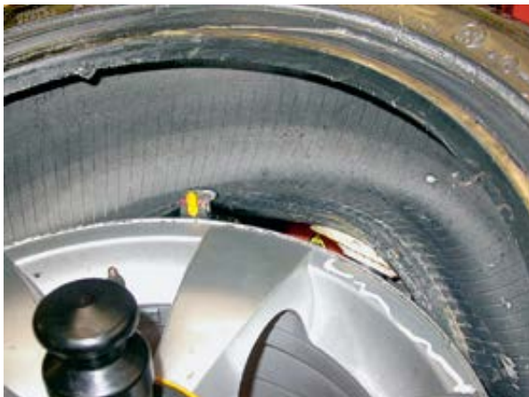
Bild 53 Ventilstellung beachten: Demontage der unteren Wulst.
