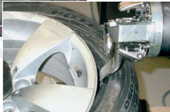
Bild 51 Vorsichtig vorgehen: Wulst über das Ventil heben, ohne dies zu berühren.
