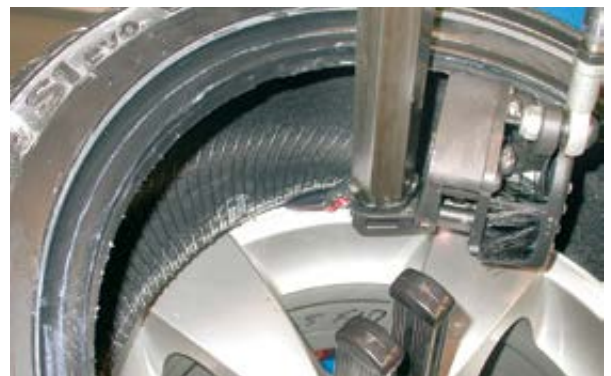
Bild 55 Abstand halten: Den Montagekopf richtig positionieren, um die untere Wulst schadenfrei über das Felgenhorn zu drücken.
