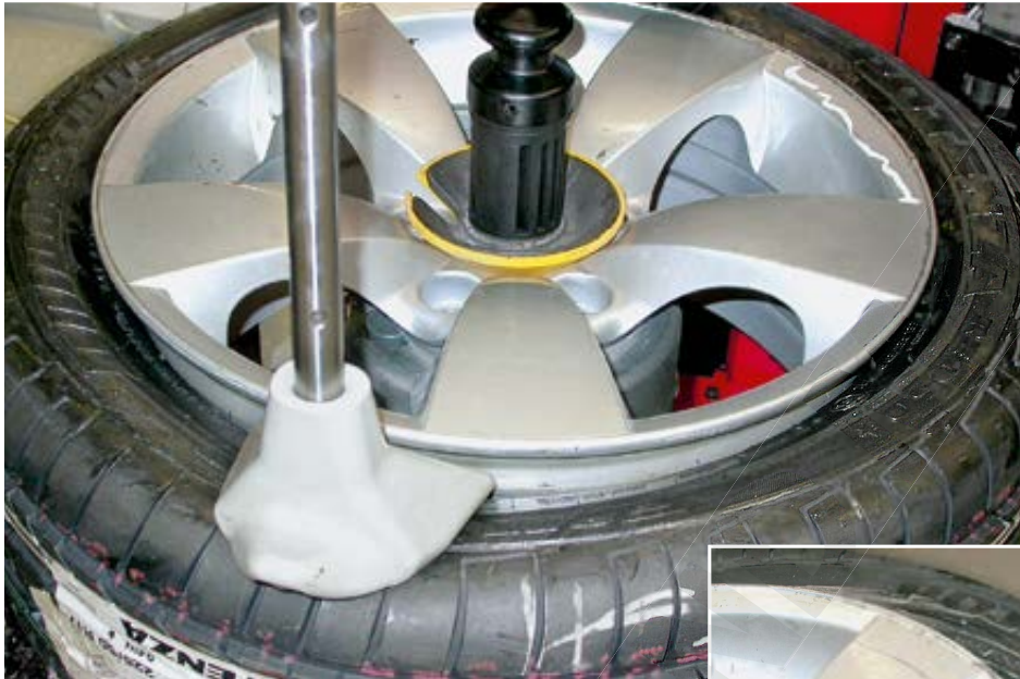
Bild 50 Pneumatischer Niederdrücker: Reifen gegenüber dem Montagekopf in das Tiefbett drücken.
