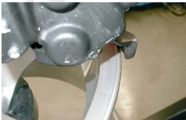
Bild 54 Montagekopf einstellen: Dabei auf den richtigen Abstand zwischen Montagekopf und Felgenhorn achten.
