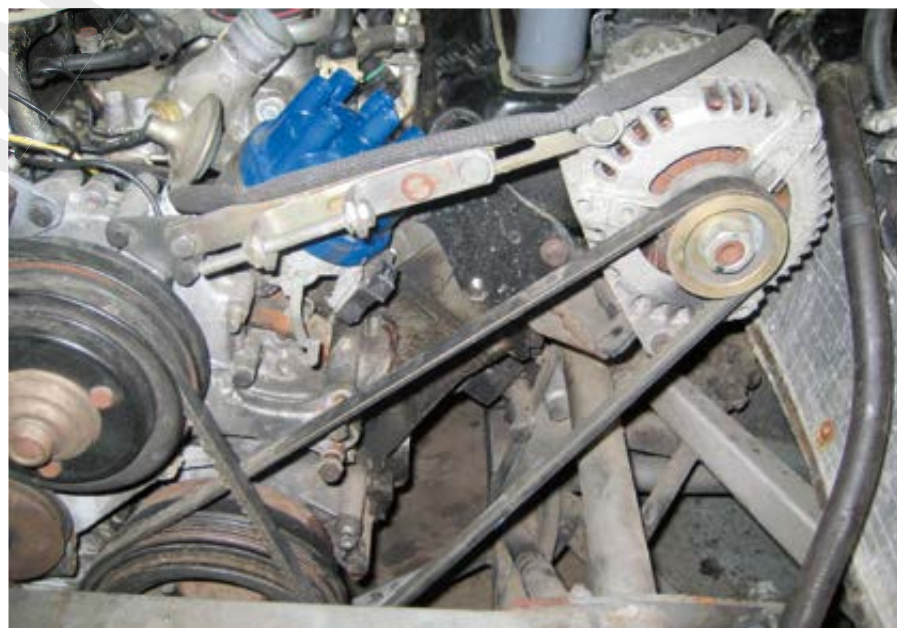
Bild 21 Eindeutig vibrationsfördernd: Linear verstellbarer Riemen Spanner älterer Bauart. Bild: Rainer Lehnen / www.chimaera500.oyla14.de
