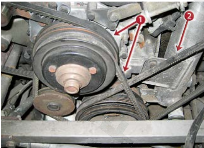
Bilder 3+4 Vergleich: Trapezkeilriemen (1) sind den moderneren Keilrippenriemen (2) bei Anzahl und Leistungsbedarf der angetriebenen Aggregate deutlich unterlegen. Sie benötigen entsprechend mehr axialen Bauraum. Kombinationen sind jedoch möglich. Bilder: Rainer Lehnen / www.chimaera500.oyla14.de
