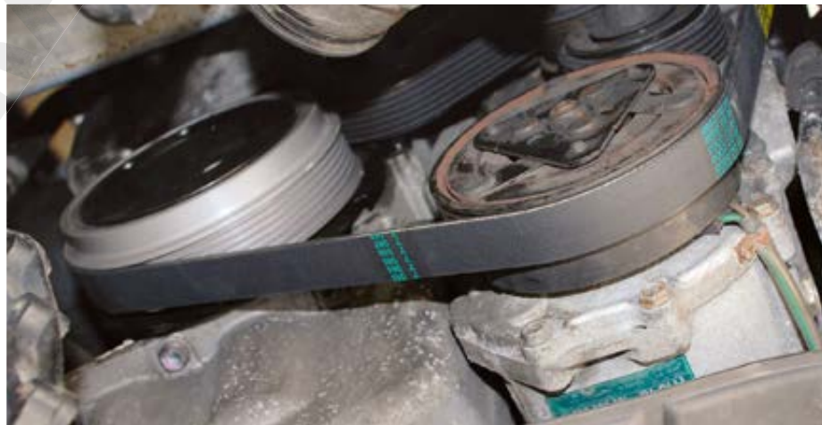
Entkoppelte Riemenscheibe & Co.: Im Bereich des Riementriebs ist sorgfältiges Arbeiten gefragt. Die Kenntnis von fahrzeugspezifischen Daten ist dringend notwendig. Bild: Blenk
