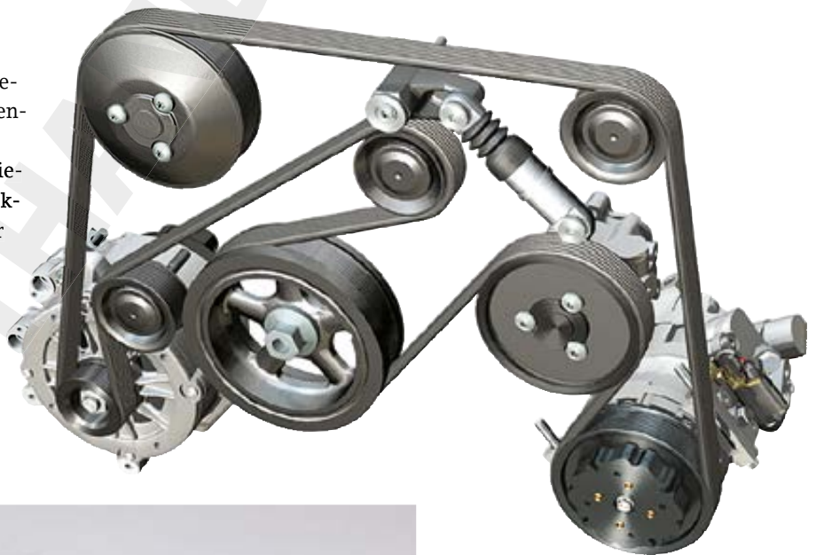
Bild 15 Drehpunkte: Vor allem kleine Riemenscheibendurchmesser erfordern große Umschlingungswinkel, um hohe Leistungen übertragen zu können. Bild: Schaeffler
