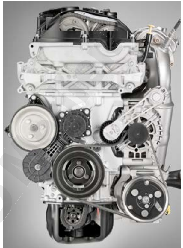
Bild 32 Intelligente Steuerung: Schaltbarer Aggregateantrieb mit ‚Friction wheel‘. Bild: BMW Group
