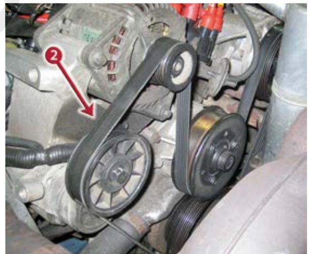
Bilder 3+4 Vergleich: Trapezkeilriemen (1) sind den moderneren Keilrippenriemen (2) bei Anzahl und Leistungsbedarf der angetriebenen Aggregate deutlich unterlegen. Sie benötigen entsprechend mehr axialen Bauraum. Kombinationen sind jedoch möglich. Bilder: Rainer Lehnen / www.chimaera500.oyla14.de
