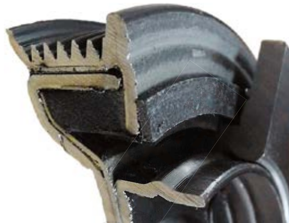
Bild 20 Schwingungsdämpfer: Entkoppelte Riemenscheibe. Bild: Bilsteingroup
