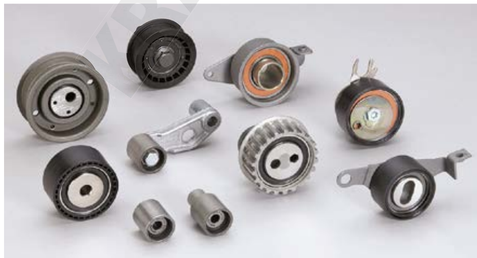
Bild 15 Drehpunkte: Vor allem kleine Riemenscheibendurchmesser erfordern große Umschlingungswinkel, um hohe Leistungen übertragen zu können. Bild: Schaeffler
